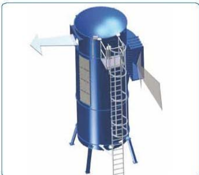
Jet-filtret med skrabebund och tangentiellt inlopp. Vist med explosionsavlastning i sidan. Monteret med stige och plattform.
