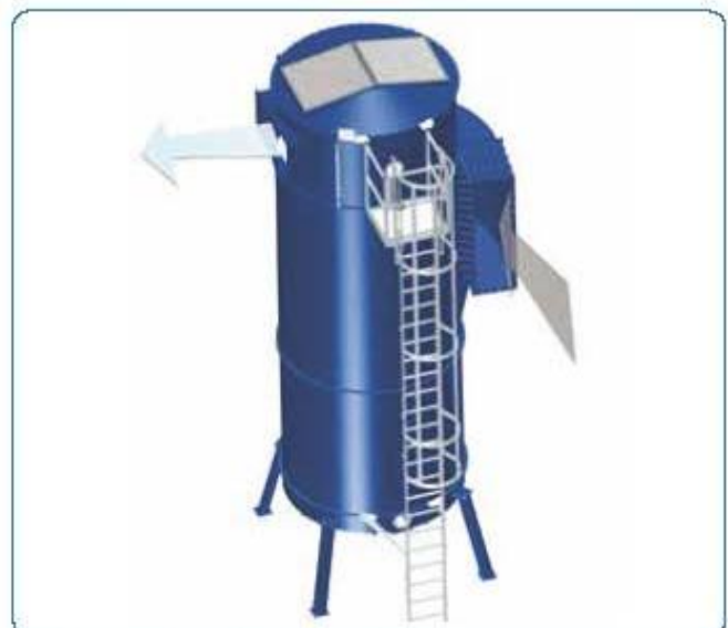
Jet-filtret med skrabebund och tangentiellt inlopp. Vist med VFV®-explosionsavlastning i filtertoppen. Monteret med stige och plattform.
