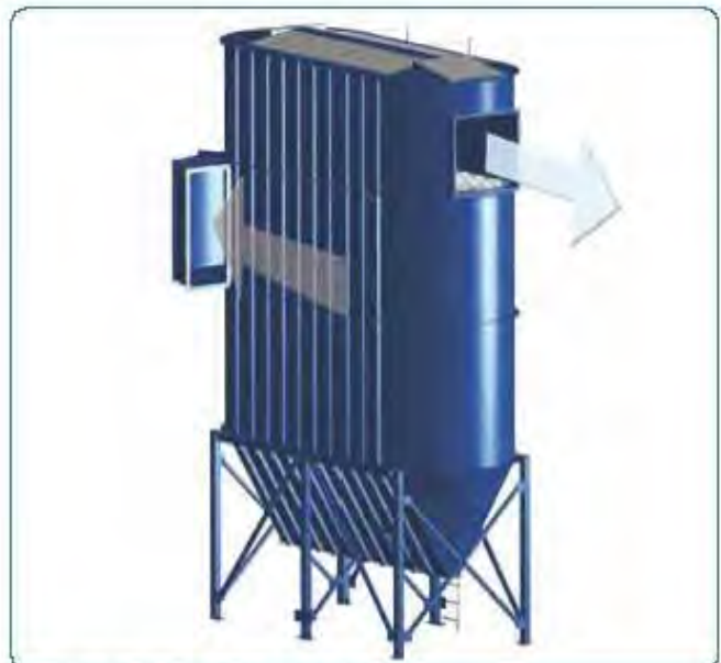
SBF-filtret med keglebund och tangentiellt inlopp. Her vist med VFV®-explosionsavlastning i filtertoppen.
