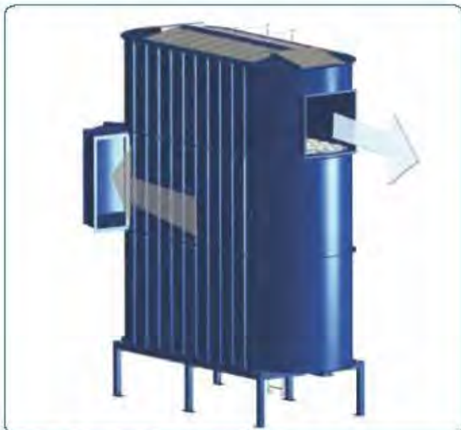
SBF-filtret med skrabebund och tangentiellt inlopp. Her vist med VFV®-explosionsavlastning i filtertoppen.
