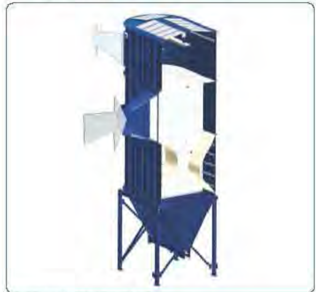
SBF-filter med keglebund og sideinlopp. Snittet viser Coandapladerne, som accelererer og fortætter partiklerne, så de falder ned i filterbunden.
